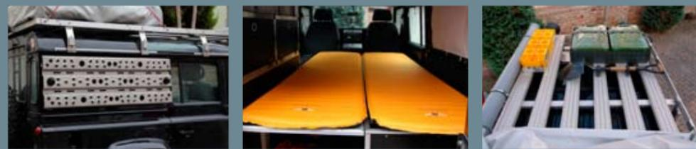
Oben: Der aus Aluminium und Siebdruckplatten selbst gebaute Innenausbau
